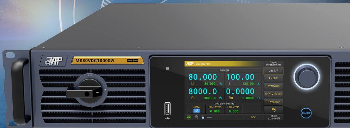
Momentum S系列为单路输出可编程直流电源, 单相或三相输入方式可供选择, 支持全球通用输入电压。采用高功率密度结构设计, 2U体积内实现10kW输出功率, 可通过光纤并机以满足更高功率需求。同时采用宽范围输出设计, 在满功率输出时扩展了电流和电压的输出范围, 使用更灵活。
